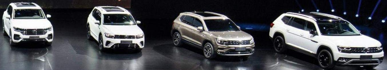
Als drittes SUV kommt nun der neue Touareg zu Tiguan und Teramont. Anders als bei uns spielen Dieselmotoren in China keine Rolle. Deshalb erhält der Touareg einen V6-Benziner mit 340 PS. Zudem ist ein neuer Plug-in-Hybridantrieb mit einer Systemleistung von 367 PS und einer elektrischen Reichweite von 58 Kilometern in Entwicklung, der auch nach Europa kommen soll.
